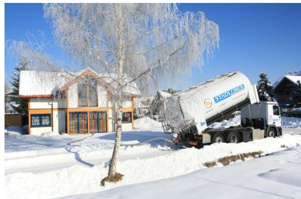
**Abb. 5: Holzpelletszustellfahrzeuge, Bild links: kurze Entfernung zum Füllstutzen – optimale Produktschonung durch kurze Schlauchlänge; Bild rechts: gängige Größe eines Holzpelletszustellfahrzeuges (Quelle: Stadlober GmbH)**
