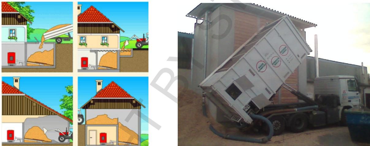
Abb. 3: Verschiedene Varianten der Lagerraumbefüllung mit Hackgut (Quelle: Bild links: Regionalenergie Steiermark; Hackgutpumpwagen Bild rechts: Stadlober GmbH)
